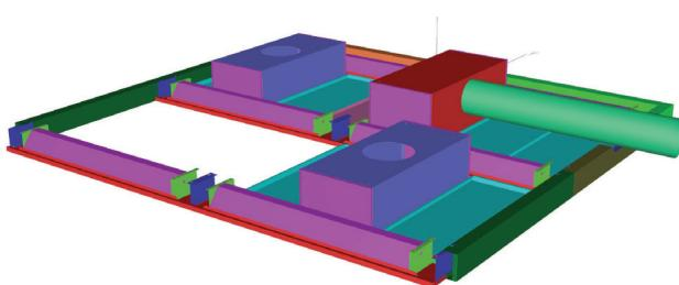
Par sa conception « fermé » le plafond Hygroplaf extrait la chaleur et la vapeur et réinsuffle l'air de compensation au travers de cassettes hermétiques. Ces dernières sont raccordées directement aux réseaux de gaine ne laissant aucune possibilité de dépôts sur les structures et autres équipements du bâtiment. Cette conception répond de ce fait aux règles les plus strictes d'hygiène.
