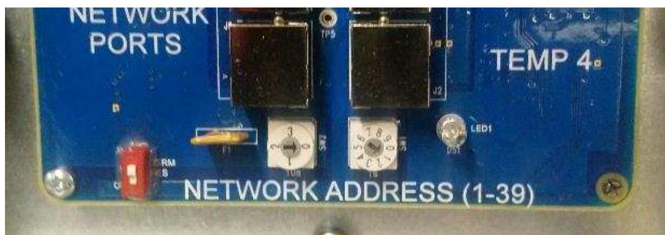
Tous les contrôleurs de hotte possèdent un swith on/off dans la partie inférieure droite de la platine. Tous les switchs doivent être sur la position OFF, à l'exception des contrôleurs de hottes en bout de ligne (c'est-à-dire ceux qui n'ont qu'un seul port « HOOD NETWORK PORT » utilisé).
